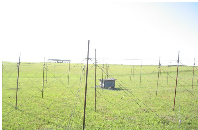
Figura 3.3 – Fotografia das antenas do Riômetro Imageador no Observatório Espacial do Sul, OES/CRS/CCR/INPE – MCT 29,4°S, 53,8°O 480 m de altitude, em São Martinho da Serra, RS.
